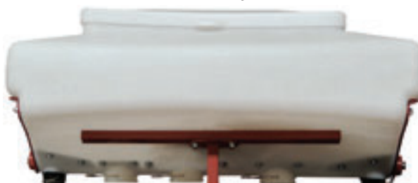
Zbiornik na nawozy siewników VEGA PROFI o pojemności 180 l.
